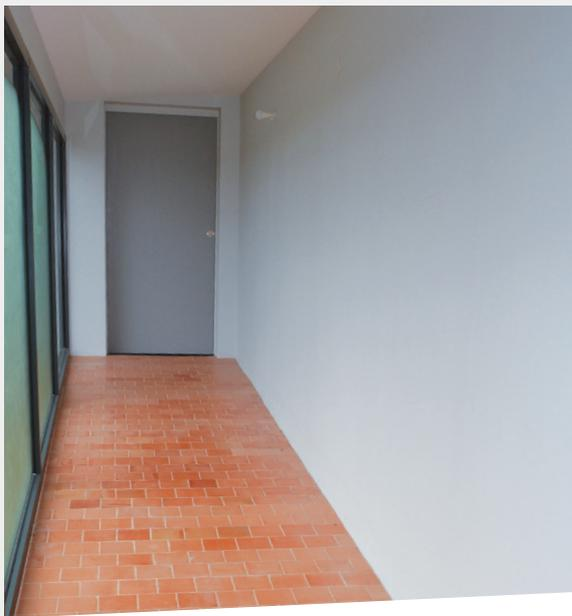
**Les couloirs** ont idéalement une largeur minimale de 1,20m et sont implantés, autant que faire se peut, de façon à permettre la circulation avec des béquilles, un fauteuil roulant...
